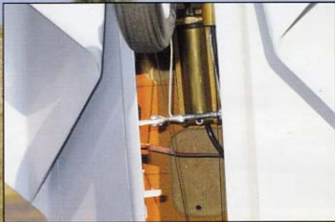
Les mécaniques de train Spring Air, et les trappes, commandées par un système mécanique réalisé en corde à piano.
