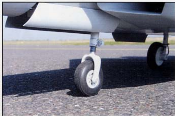
Lionel a façonné lui-même les jantes, mais aussi les jambes de train amorties.
