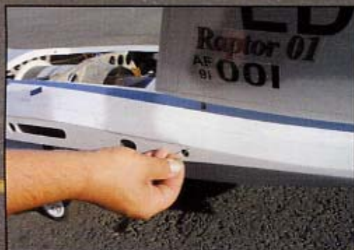
Les dérives démontables se verrouillent avec une corde à piano de 0,8 mm.
