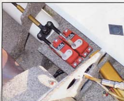
Chaque stabilisateur est actionné par deux servos couplés mécaniquement.
