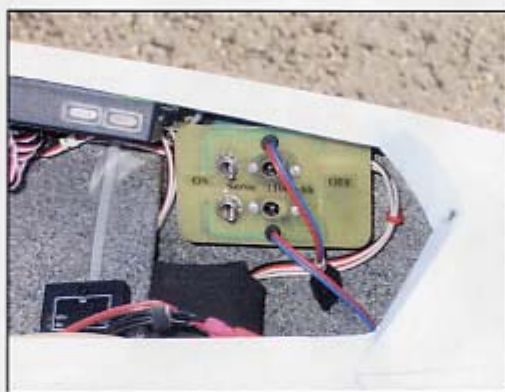
L'intérieur du fuselage est peint "granité", et les inters sont accessibles facilement par l'ouverture du cockpit.
