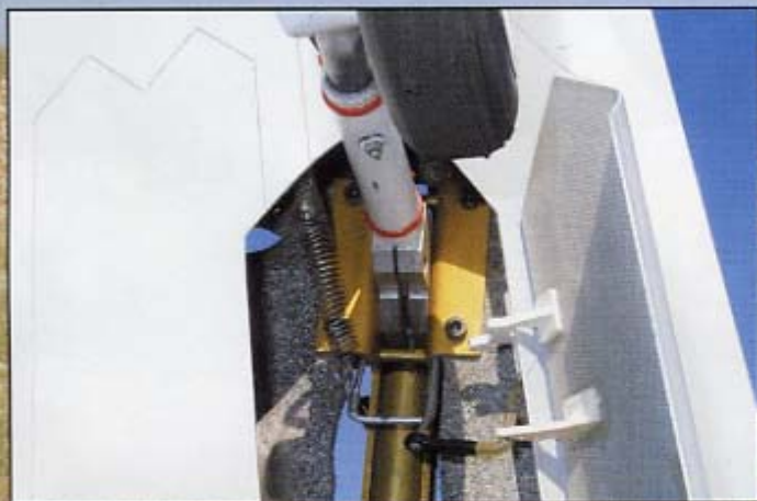
Les mécaniques de train Spring Air, et les trappes, commandées par un système mécanique réalisé en corde à piano.
