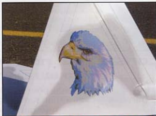
Le décor est réalisé par ordinateur, imprimé sur de l'adhésif transparent, puis protégé par un vernis.
