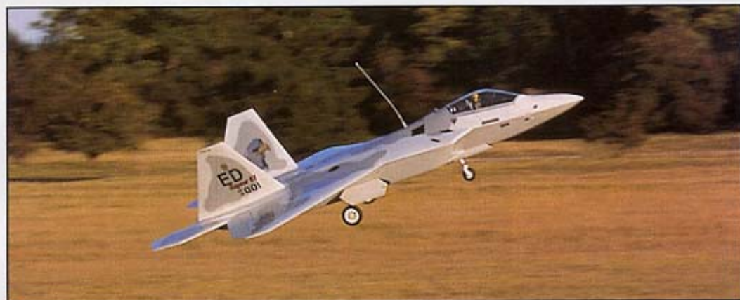
13,6 kg de poussée pour un avion de 11 kg. Aucun doute, ça pousse fort !
