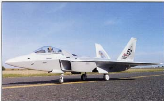
Les lignes du Raptor sont vraiment particulières, avec son aile en diamant et ses entrées d'air en forme de losange.
