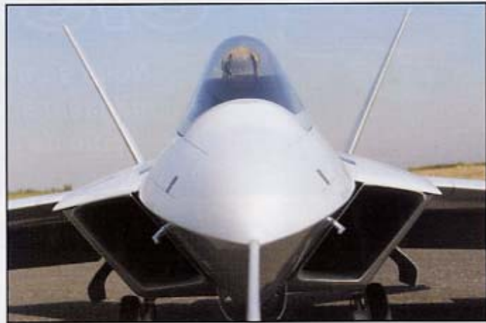
Cette vue de face dévoile les entrées d'air, regroupées en une veine commune dans le fuselage.
