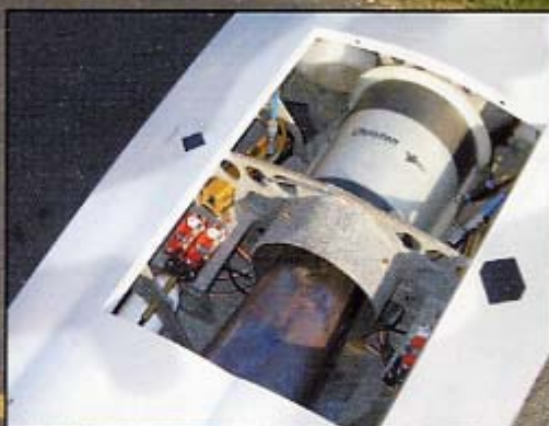
Le réacteur est logé au centre du fuselage, dans un conduit moulé.
