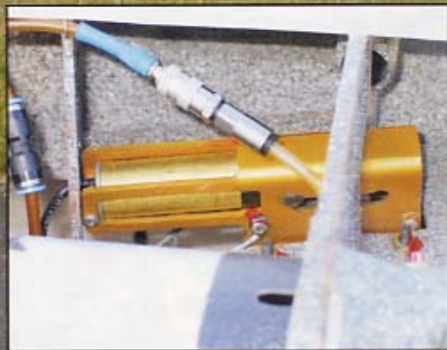
Les mécaniques de train Spring Air, et les trappes, commandées par un système mécanique réalisé en corde à piano.
